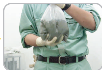
③袋をもんで、補修材と樹脂をよく練り混ぜてください。（2分程度）
